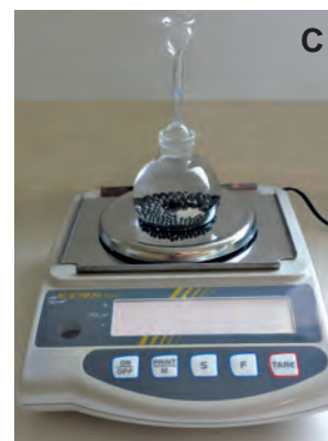
Massa do picnômetro com a amostra do metal e com água até ao traço de referência ( m_C )
